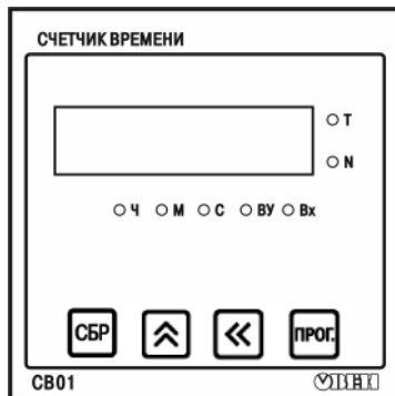
Рисунок 6.2 – Лицевая панель прибора для корпусов настенного Н и щитового Щ1 креплений
