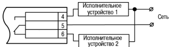
Рисунок 5.3 – Схема подключения нагрузки к ВУ типа Р
